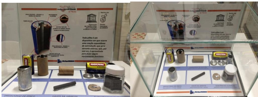
Imagem 4 – Maquete desenvolvida para demonstração das partes interiores de uma pilha seca comum.
